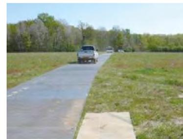
*Figure 68 : Exemple de plaque mobile de répartition de charge*
